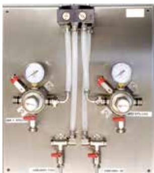
**GAS951-BGR** Gasmischer Gasversorgung 2Gemische mit voreingestellter Mischung 55%/45% und 61%/39% incl. 2 Ausgangsdruckminderer 3bar mit Sicherheitsventil. Separate Ausgänge m. Kugelabsperrhähnen. Montiert auf VA-Wandplatte 510 x 400 x 140mm.
